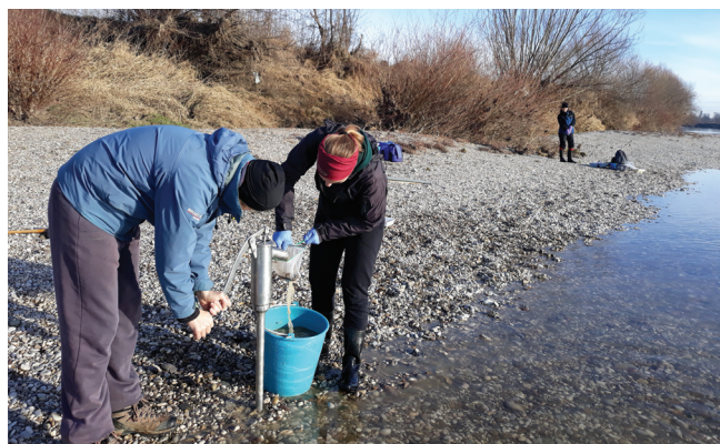
Slika 2 – Uzorkovanje hiporeičke faune na šljunčanom sprudu rijeke Save kod jezera Jarun (foto M. Erk)
