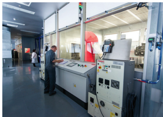
Slika 6 – Upravljanje procesima u komorama lakirnice odvija se izvan komore (izvor: AD Plastik)
