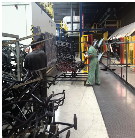
Slika 4 – Ručno premještanje nosača na transportnu traku. Na nosače koji odgovaraju svakom proizvodu učvršćuju se dijelovi koji se obrađuju u kabinama lakirnice. Postoji rizik od pada nosača u slučaju ne pridržavanja propisanog radnog postupka (izvor: AD Plastik).
