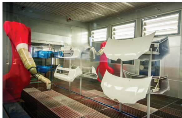
Slika 5 – Pogon lakirnice, robotska ruka za nanošenje premaza i pokretna traka s branicima (izvor: AD Plastik)
