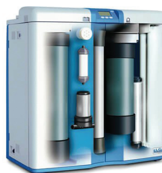
Slika 5 – Sustav CENTRA-R60 R120 stvorio je revoluciju u načinu proizvodnje, skladištenja i distribucije čiste vode. Umjesto tradicionalno dizajniranog središnjeg laboratorijskog sustava, koji se sastoji od neurednog grupiranja komponenta i cjevovoda, postoji samo jedan integrirani uređaj. Anorganski sastojci: M\Omega\text{ cm} > 10 ; organske tvari (TOC): ppb < 20; bakterije: CFU/ml < 1; protok 10 (l min -1 ) @ 1,5 bar (izvor: https://www.evoqua.com/ ).
