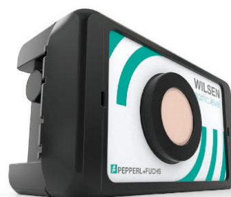
Slika 5 – WILSEN.sonic.level bežični je senzor tvrtke Pepperl+Fuchs s integriranim ultrazvučnim modulom za mjerenje razine. Dostupan je za bežičnu GSM (2G) i LoRaWAN komunikaciju a ima vijek trajanja baterije do pet godina. Ugrađeni GPS čip omogućava precizno praćenje uređaja. Prenose se i informacije o stanju uređaja, poput temperature i trajanja baterije. Zbog IP66/67 ocjene i PTFE zaštitnog filma koji sprječava lijepljenje kontaminacije na pretvaraču, senzori se smiju montirati i u teškim uvjetima. Ugrađena kompenzacija temperature omogućuje širok raspon radne temperature (od -25\text{ }^{\circ}\text{C} do +70\text{ }^{\circ}\text{C} ) i omogućuje tim sensorima pouzdano mjerenje razine, kako na otvorenom tako i u teškim uvjetima (izvor: https://www.pepperl-fuchs.com/ )
