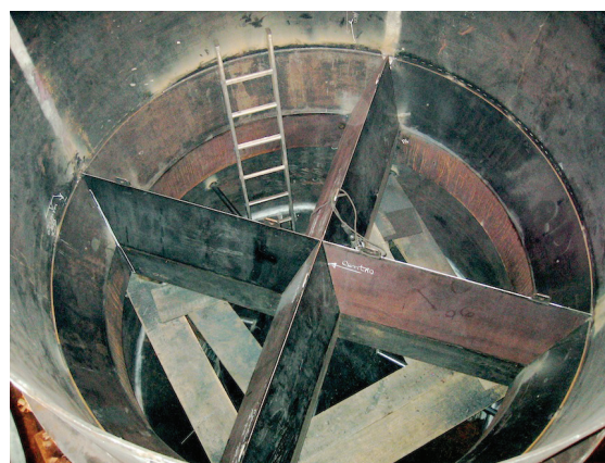
Slika 2 – Fotografija umetka u lijevku u obliku obrnutog slova V (izvor: http://jenike.com )
