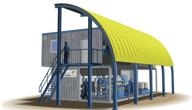
Slika 1 – EnviModul modularno postrojenje za obradu vode (izvor: http://www.chemeurope.com )
