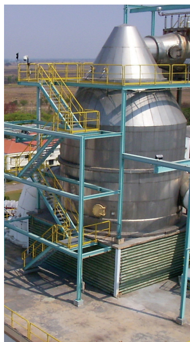
Slika 6 – Kristalizator s protočnom cijevi (eng. draft-tube ) (izvor: http://www.gea.com )
