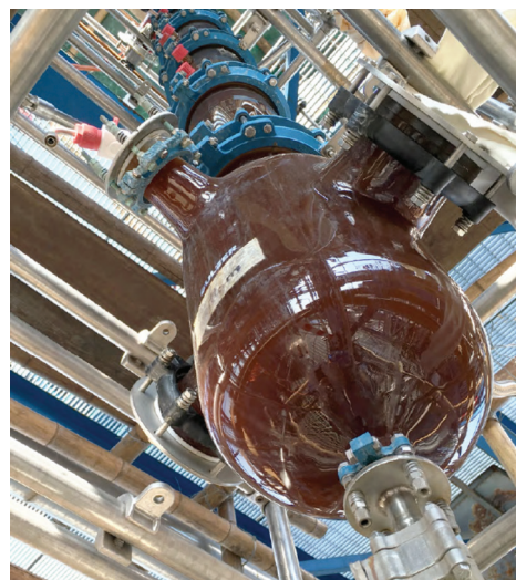
Slika 1 – Oprema za ekstrakciju koja se posuđuje za provedbu pilot ispitivanja (izvor: http://www.sulzer.com/ )
