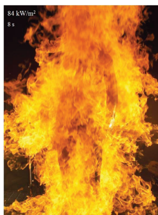
Slika 5 – Prikaz uvjeta i procjena opekline tijekom ispitivanja različitih odijela na lutki
