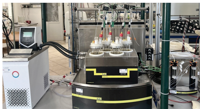
Slika 2 – Kristalizacijski sustav za preliminarno istraživanje
