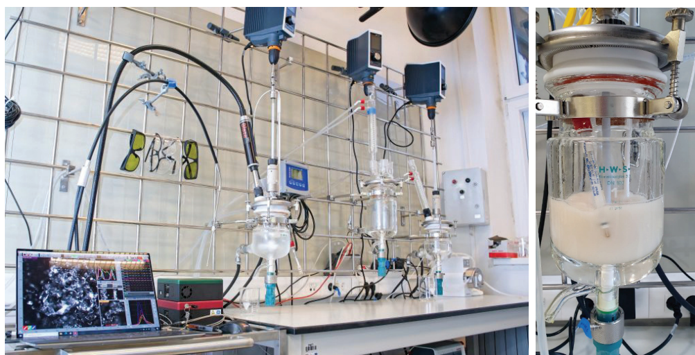
Slika 1 – Laboratorijski sustav za napredno vođenje procesa kristalizacije
