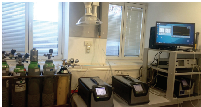
Slika 6 – Umjerni laboratorij za umjeravanja emisijskih analizatora plinova.
