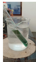
Slika 7 – Dokazivanje prisutnosti šećera u uzorku pića Coca-Cola Zero: nastanak zelenkaste otopine umjesto crvenosmeđeg taloga ukazuje na izostanak pozitivne reakcije
