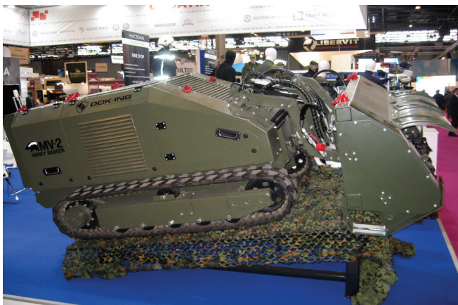
Slika 2 – Honey Badger – novi Dok-Ingov stroj MV-2 jedini je stroj na svijetu za uništavanje mina koji se može transportirati helikopterom.
