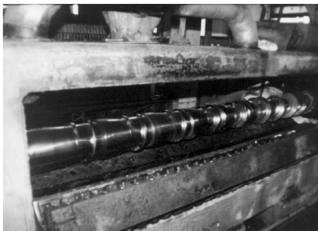
Slika 1 – Izgled otvorene pužne preše s rasporedom radnih dijelova
